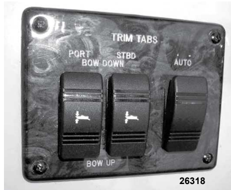
Interruptores típicos de controle automático e manual de compensadores
