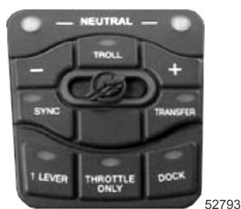
Panel DTS montowany na tablicy przyrządów
