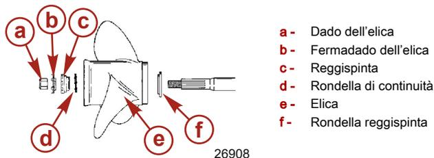
3. Eliche con parastrappi Flo-Torq II – Installare il reggispinta anteriore, il manicotto di trasmissione sostituibile, l'elica, il reggispinta, il fermo del dado dell'elica e il dado dell'elica sull'albero.
