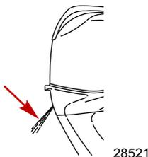
**IMPORTANTE:** se dal foro indicatore della pompa dell'acqua non fuoriesce acqua, spegnere il motore e verificare che la presa dell'acqua di raffreddamento non sia ostruita. Se non sono presenti ostruzioni, la pompa dell'acqua è guasta oppure l'impianto di raffreddamento è ostruito. Queste condizioni causano il surriscaldamento del motore. Far revisionare il fuoribordo dal concessionario di fiducia. Se il motore viene lasciato in funzione in condizioni di surriscaldamento, si può danneggiare.
