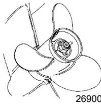
4. Collocare un blocco di legno tra la scatola ingranaggi e l'elica per impedire che l'elica ruoti. Rimuovere il dado dell'elica.
