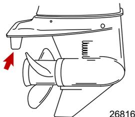
**NOTA:** la regolazione della pinna di compensazione ha un effetto minimo sulla torsione se il fuoribordo è installato con la piastra di antiventilazione a circa 50 mm o più dal fondo dell'imbarcazione.
