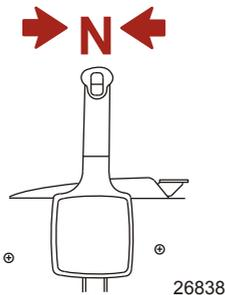
5. Spostare la leva di sola accelerazione in posizione completamente chiusa o premere il pulsante di sola accelerazione.
