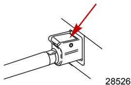
3. Posizionare la pompetta di adescamento del tubo di alimentazione del combustibile in modo che la freccia sul lato della pompetta sia rivolta verso l'alto. Premere la pompetta di adescamento del tubo di alimentazione del combustibile varie volte, fino a quando non si irrigidisce.
