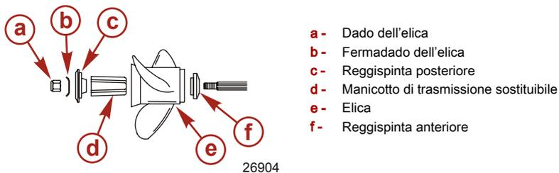
4. Posizionare il fermo del dado dell'elica sui perni. Collocare un blocco di legno tra la scatola ingranaggi e l'elica e serrare il dado dell'elica secondo le specifiche.
