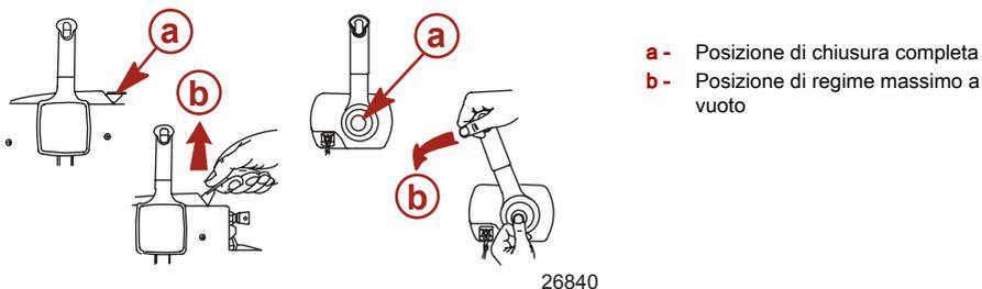
6. Avvio di un motore ingolfato – Far avanzare la leva di sola accelerazione o la leva di comando in posizione di sola accelerazione massima e insistere con la procedura di avviamento del motore. Ridurre il regime non appena il motore si avvia.
