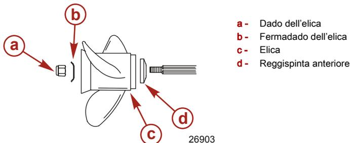
3. Eliche con parastrappi Flo-Torq II – Installare il reggispinta anteriore, l'elica, il manicotto di trasmissione sostituibile, il reggispinta posteriore, il fermo del dado dell'elica e il dado dell'elica sull'albero.
