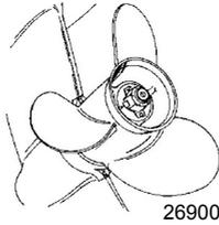
4. Collocare un blocco di legno tra la scatola ingranaggi e l'elica per impedire che l'elica ruoti. Rimuovere il dado dell'elica.
