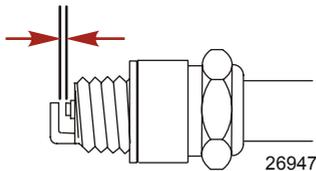
4. Prima di reinstallare le candele, eliminare ogni traccia di sporcizia dalla sede. Installare le candele serrandole a mano, avvitarle di 1/4 di giro e serrarle a 27 Nm (20 libbre piedi).
