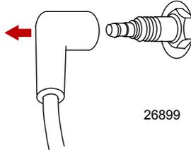
2. Rimuovere le candele per ispezionarle. Sostituire le candele se l'elettrodo è logorato o se l'isolante appare irruvidito, crepato, rotto, vaiolato o sporco.
