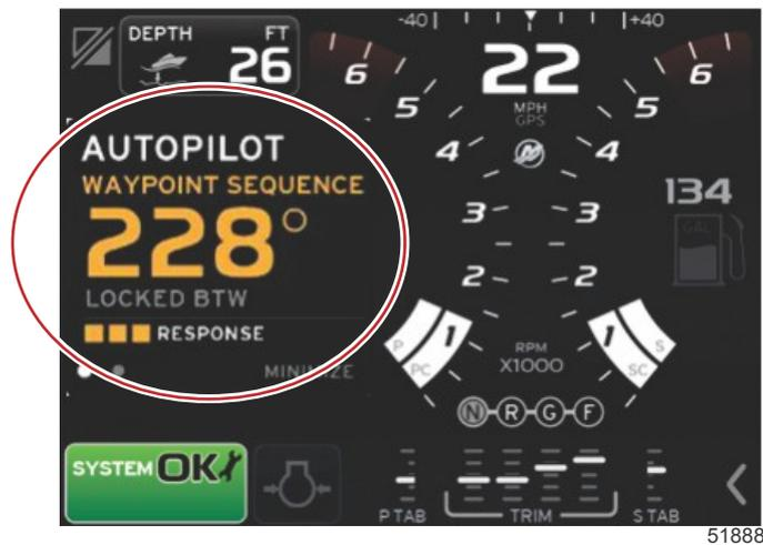
6. Si le bateau est dans la zone d'arrivée d'un point de cheminement défini par le traceur graphique, le mode Waypoint sequence (Séquence de points de cheminement) informe uniquement le pilote automatique qu'il peut poursuivre jusqu'au point de cheminement suivant. Le mode Waypoint sequence (Séquence de points de cheminement) agit comme une fonction de reconnaissance d'un point de cheminement et le pilote automatique émet un bip lorsqu'il est dans la zone.
