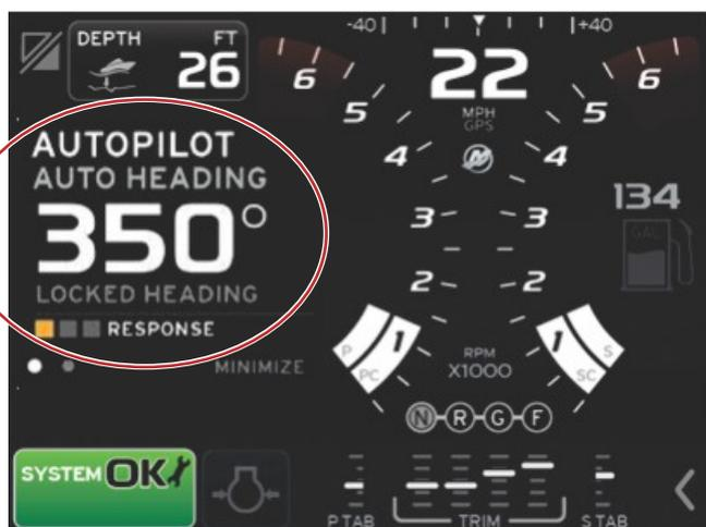
5. Pour régler la course lorsque le mode Auto heading (Cap automatique) est activé, voir **Réglage de la course en utilisant les boutons « Turn » (Tourner) ou la manette**.
