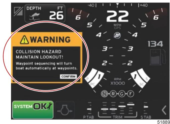
8. Rester vigilant. Le bateau se met automatiquement dans ce mode. Le pilote doit s'assurer qu'il est possible de virer sans danger lors de l'entrée dans la zone d'arrivée d'un point de cheminement. Il doit informer les passagers que le bateau vire automatiquement afin qu'ils s'y préparent.
