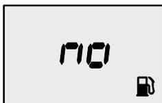
**REMARQUE** : le mot « no » reste affiché jusqu'à ce que l'indicateur enregistre la connexion d'un réservoir au système. Si aucun réservoir n'est relié, vous ne pouvez pas saisir de capacité.
