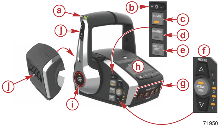
ERC Premier à poignée double pour quatre moteurs affichée, les autres sont similaires
