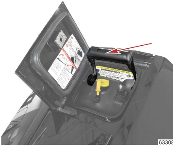
**Levier verrouillé dans la position de levage**
