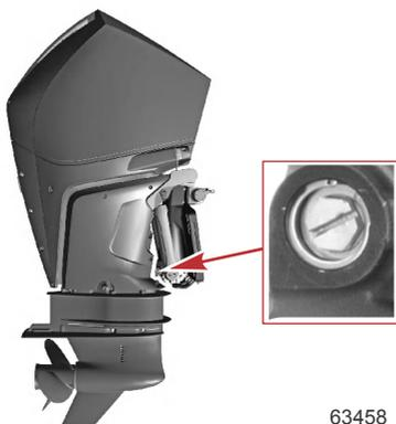
**REMARQUE :** La valve de desserrage du relevage manuel doit être serrée avant toute utilisation du moteur hors-bord pour éviter que ce dernier ne se relève lors d'un fonctionnement en marche arrière.
