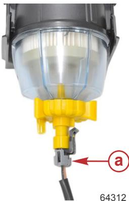
a - Connecteur de capteur de présence d'eau dans le carburant
