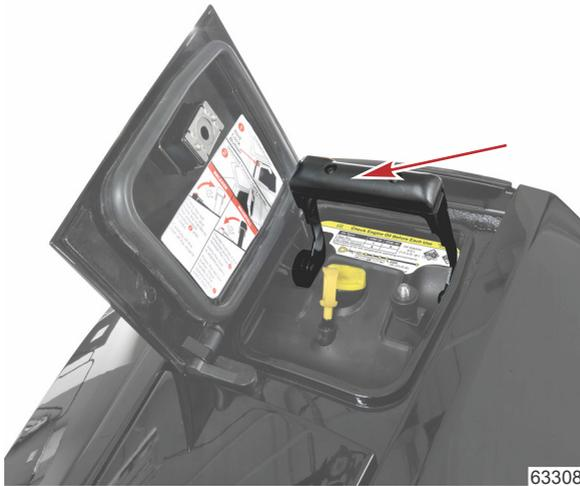
**Levier verrouillé dans la position de levage**
