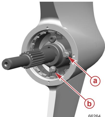
**a** - Bouchon de contrôle du niveau de lubrifiant
