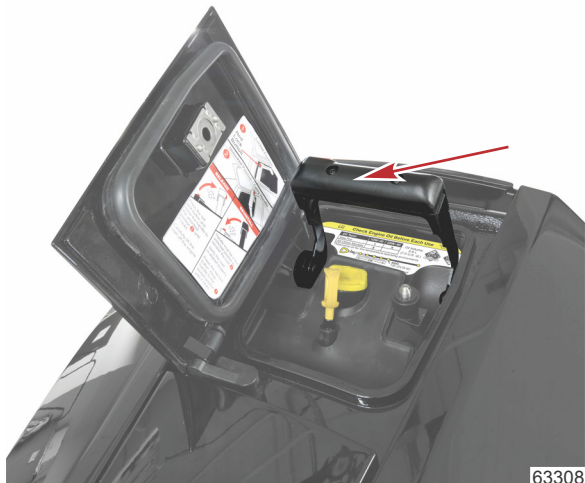
Levier verrouillé dans la position de levage
