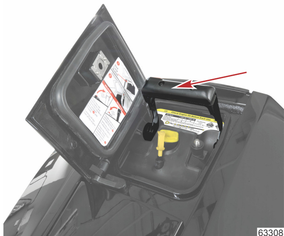
Levier verrouillé dans la position de levage
