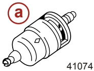
a - Filtre à carburant
