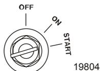
10. Démarrage du moteur noyé – Avancer le levier de ralenti accéléré ou le dispositif spécial d'accélération en position maximale. Sans activer le dispositif d'amorçage, lancer le moteur pendant 10 secondes. Attendre 30 secondes puis recommencer jusqu'à ce que le moteur démarre. Commencer immédiatement à réduire le régime lorsque le moteur démarre.
