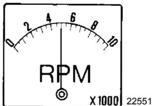
Si des conditions changeantes (temps plus chaud et plus humide, utilisation à des altitudes supérieures, charge plus élevée du bateau ou fond de coque/carter d'embase sales) entraînent la baisse du régime en dessous de la plage recommandée, un changement d'hélice ou un nettoyage peuvent s'avérer nécessaires pour maintenir le niveau optimal des performances et assurer la durabilité du moteur hors-bord.
