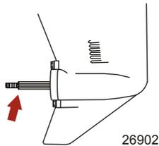
2. Graisser les éléments suivants avec de la graisse Quicksilver ou Mercury 2-4-C avec PTFE.
