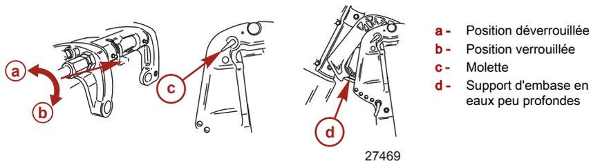
4. Saisir la poignée du capot supérieur et relever le moteur hors-bord pour permettre au support d'embase en eaux peu profondes de basculer.
