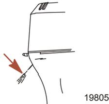
Si de l'eau ne s'écoule pas de la pompe à eau ou si le jet est intermittent, arrêter le moteur et vérifier que les orifices d'admission d'eau de refroidissement ne sont pas bouchés. En cas d'absence d'obstruction, un blocage dans le circuit de refroidissement ou un problème avec la pompe à eau est probable. Faire vérifier le hors-bord par le revendeur. Le moteur sera endommagé s'il surchauffe.
