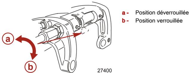
**REMARQUE :** Le verrouillage du relevage n'empêche pas le moteur hors-bord de se relever si un obstacle immergé est heurté.
