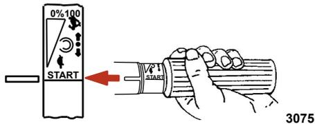
9. Modèles à commande à distance – Mettre la commande « ON/OFF » (Marche/arrêt) sur « ON » (Marche).
