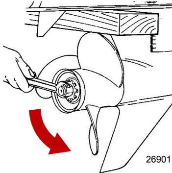
5. Retirer l'hélice de l'arbre en la tirant directement. Si l'hélice est grippée sur l'arbre et ne peut pas être retirée, la faire retirer par un revendeur agréé.
