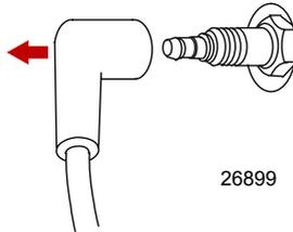
2. Retirer les bougies pour vérifier leur état. Remplacer les bougies si les électrodes sont usées ou si l'isolant est rugueux, fendu, cassé, cloqué ou encrassé.
