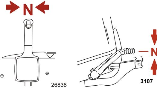
7. Placer le levier de verrouillage de relevage en position verrouillée.
