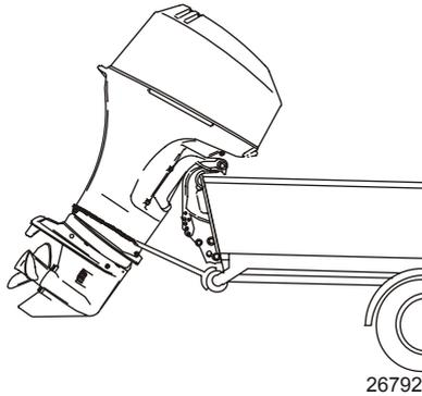
**IMPORTANT : Ne pas se fier au système de relevage hydraulique / trim ni au levier de support de relevage afin de maintenir un dégagement suffisant pour le remorquage. Le levier de support de relevage n'a pas été conçu pour soutenir le moteur durant le remorquage.**
