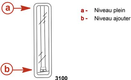
2. Retirer le bouchon de remplissage du réservoir d'huile et remplir ce dernier.
