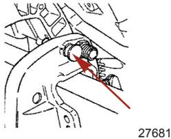
2. Enlever le bouchon de remplissage et vérifier le niveau d'huile hydraulique. Ce dernier doit atteindre le bas de l'orifice de remplissage. Faire l'appoint en utilisant Quicksilver ou Mercury Precision Lubricants Power Trim & Steering Fluid. Si cela n'est pas possible, utiliser de l'huile pour transmission automatique automobile.
