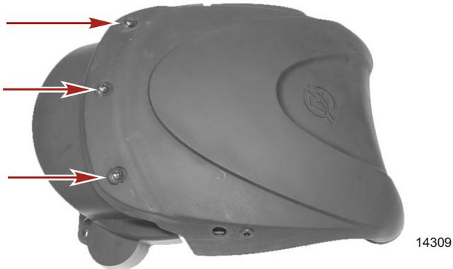
5. Séparer les deux couvercles du volant moteur pour accéder au filtre à air.
