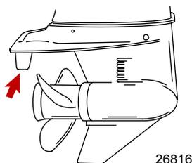
**REMARQUE :** Le réglage de la dérive aura peu d'effets sur la réduction du couple de direction si le moteur hors-bord est installé avec la plaque anti-ventilation à environ 50 mm ou plus au-dessus du fond du bateau.
