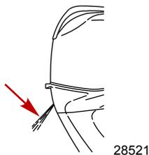
**IMPORTANT** : Si de l'eau ne s'écoule pas de l'orifice de la pompe, arrêter le moteur et vérifier que l'orifice d'admission d'eau de refroidissement n'est pas obstrué. S'il n'y a aucune obstruction, la pompe à eau peut être défectueuse ou le circuit de refroidissement peut être bouché. Dans ces conditions, le moteur surchauffe. Faire vérifier le moteur hors-bord par le revendeur. Le moteur sera endommagé s'il tourne alors qu'il surchauffe.
