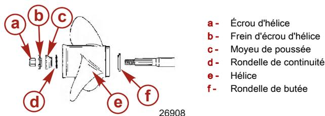
3. Hélices à moyeu d'entraînement Flo-Torq II – Installer le moyeu de poussée avant, la douille d'assemblage remplaçable, l'hélice, le moyeu de poussée, le frein d'écrou d'hélice et l'écrou d'hélice sur l'arbre.
