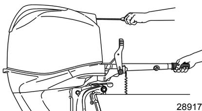
9. Modèles à démarrage électrique – Mettre la clé de contact sur « START » (Démarrage). Si le moteur ne démarre pas au bout de dix secondes, ramener la clé sur « ON » (Marche), attendre 30 secondes, puis réessayer.
