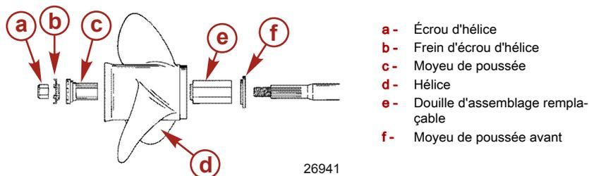
**REMARQUE :** Applications en acier inoxydable – L'installation d'une hélice à moyeu d'entraînement Flo-Torq III est recommandée.
