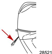
**IMPORTANT** : Si de l'eau ne s'écoule pas de l'orifice indicateur de la pompe à eau, arrêter le moteur et vérifier que l'admission d'eau de refroidissement n'est pas obstruée. S'il n'y a aucune obstruction, la pompe à eau peut être défectueuse ou le système de refroidissement peut être bouché. Ces états causent une surchauffe du moteur. Faire vérifier le moteur hors-bord par le revendeur. Le fonctionnement du moteur en état de surchauffe peut causer de graves dommages au moteur.
