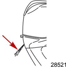
Si aucune eau ne s'écoule de l'orifice indicateur de la pompe à eau ou si le jet est intermittent, arrêter le moteur et vérifier que les orifices d'admission d'eau de refroidissement ne sont pas bouchés. L'absence d'une telle obstruction peut indiquer une obstruction du système de refroidissement ou un problème de pompe à eau. Faire vérifier le moteur hors-bord par le revendeur. Le moteur sera endommagé s'il tourne alors qu'il surchauffe.
