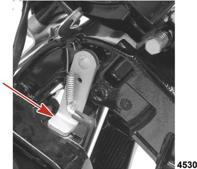
2. Enlever le bouchon de remplissage et vérifier le niveau d'huile. Le niveau d'huile doit atteindre le bas de l'orifice de remplissage. Faire l'appoint en utilisant de l'huile pour relevage hydraulique et direction assistée de Quicksilver ou Mercury Precision. À défaut, utiliser de l'huile pour transmission automatique automobile (ATF).
