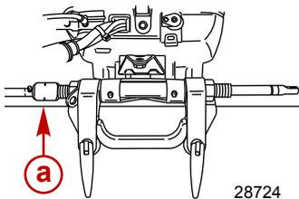
a - Écrou du câble de direction
