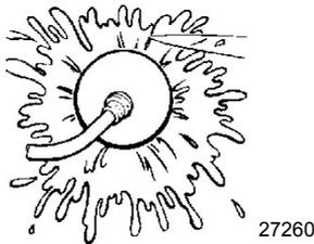
5. Vérifier qu'un jet d'eau continu s'écoule de l'orifice indicateur de la pompe à eau. Poursuivre le nettoyage du moteur hors-bord pendant 3 à 5 minutes, en surveillant attentivement et en permanence l'alimentation en eau.
