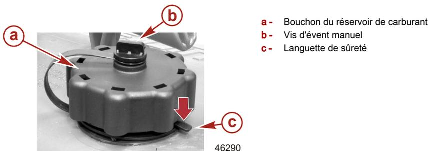
**IMPORTANT : Le contenu peut être sous pression. Faire tourner le bouchon du réservoir de carburant d'un quart de tour pour dissiper la pression avant d'ouvrir.**
