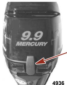
2. Lever l'avant du capot pour dégager le verrouillage avant et le pousser vers l'arrière pour dégager le crochet arrière.
