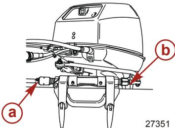
**a** - Graisseur du câble de direction
