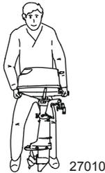
3. Porter, transporter ou remiser le moteur hors-bord dans l'une des trois positions illustrées. Dans ces positions, l'huile ne pourra pas s'échapper du carter moteur.
