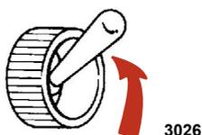
**REMARQUE :** Modèles à démarrage manuel – Pour le démarrage initial d'un moteur neuf ou le premier démarrage après une longue période de remisage, les tuyauteries d'amorçage peuvent contenir de l'air. Dans ce cas, pousser la poire d'amorçage plusieurs fois jusqu'à ce que le liquide puisse être perçu puis effectuer les 4 à 6 amorçages rapides habituels.
