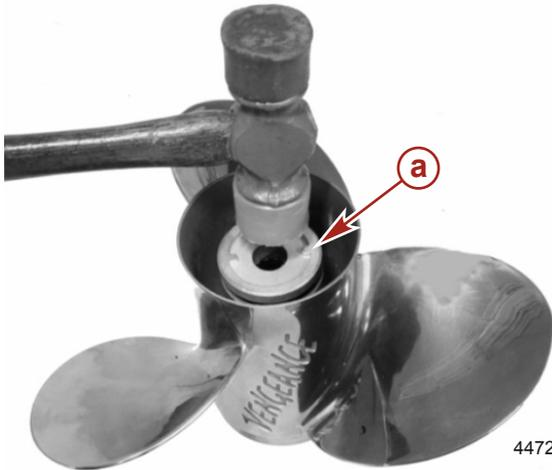
4. Installer la rondelle de butée sur l'arbre d'hélice.
