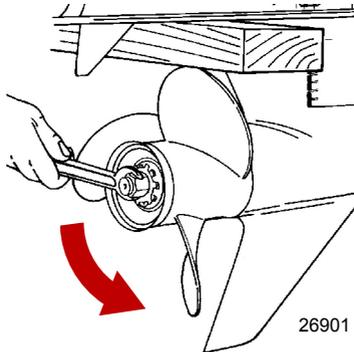
4. Retirer l'hélice et la visserie de fixation de l'arbre d'hélice.
