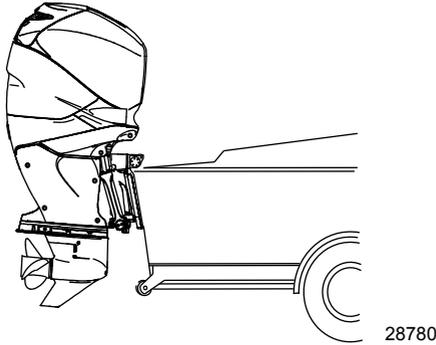
2. Si un dégagement au sol supplémentaire est nécessaire, relever le moteur et le maintenir en cette position à l'aide de son support de relevage (position de remorquage) et /ou du dispositif de support du relevage. Voir la section **Caractéristiques et commandes - Fonctionnement du relevage**.
