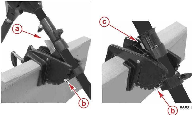
**a** - Levier de déverrouillage de relevage (modèles R3-45 et R3-55 illustrés)
