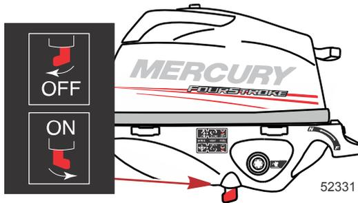
6. Attacher le coupe-circuit d'urgence à l'interrupteur d'arrêt. Voir la section **Généralités – Coupe-circuit d'urgence**.
