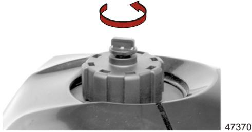
5. Mettre le robinet de carburant sur la position ouverte (ON).
