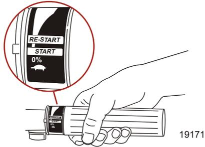
8. Si le moteur est froid, tirer à fond le starter. Enfoncer le starter à mi-course à mesure que le moteur chauffe. Le pousser à fond une fois le moteur chaud.
