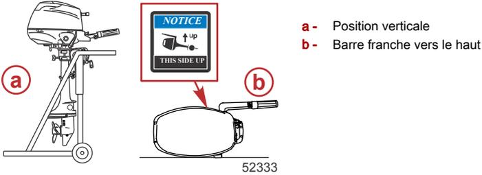
Ne jamais porter, entreposer ou transporter le moteur hors-bord dans ces positions. Le moteur peut être endommagé du fait d'un écoulement d'huile hors du carter moteur.
