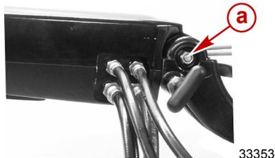
a - Vis pivot et contre-écrou
