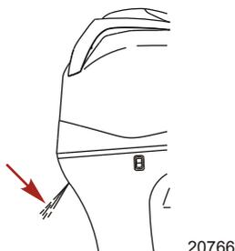
**IMPORTANT :** Si de l'eau ne s'écoule pas de l'orifice indicateur de la pompe à eau, arrêter le moteur et vérifier que l'orifice d'admission d'eau de refroidissement n'est pas obstrué. S'il n'y a aucune obstruction, la pompe à eau peut être défectueuse ou le système de refroidissement peut être bouché. Ces états causent une surchauffe du moteur. Faire vérifier le moteur hors-bord par le revendeur. Le moteur sera endommagé s'il fonctionne alors qu'il surchauffe.
