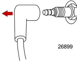
2. Retirer les bougies pour les vérifier. Remplacer les bougies si les électrodes sont usées ou si l'isolant est rugueux, fendu, cassé, cloqué ou encrassé.
