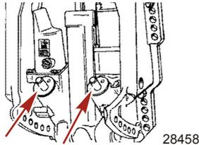
2. Appliquer une couche de graisse anticorrosion Quicksilver ou Mercury Precision ou 2-4-C au PTFE sur les éléments suivants.
