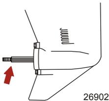
3. Lubrifier les points suivants avec du lubrifiant Quicksilver ou Mercury Precision 2-4-C au PTFE ou avec du lubrifiant spécial 101.
