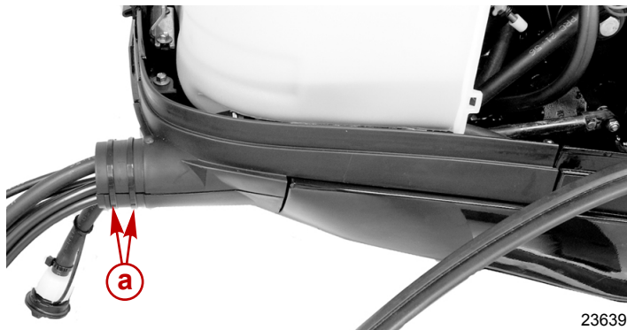
a - Attache de câble
