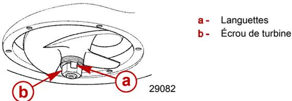
6. Extraire la turbine directement de l'arbre. Si elle ne se dégage pas facilement, la faire pivoter dans le sens horaire sur son arbre à l'aide d'un marteau et d'une cale en bois jusqu'à ce que le logement de clavette se trouve directement au-dessus de la partie plate de l'arbre. La clavette bloquée est ainsi dégagée, ce qui permet le retrait.
