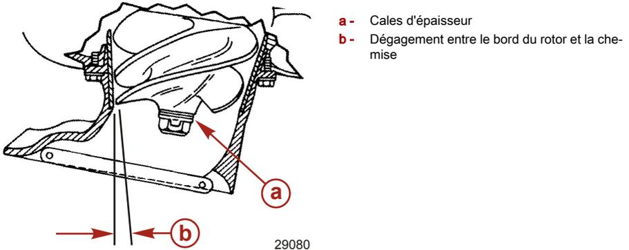
Vérifier l'écartement du rotor en insérant une jauge d'épaisseur par la grille de la prise d'eau, puis mesurer la distance entre le bord et la chemise du rotor. Si un réglage est nécessaire, voir **Installation et retrait du rotor**.
