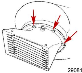
5. Redresser les languettes recourbées du frein d'écrou de la turbine puis retirer l'écrou.
