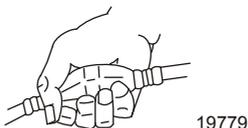
**IMPORTANT :** Pour éviter de noyer le moteur, ne pas presser la poire d'amorçage quand le moteur est chaud.
