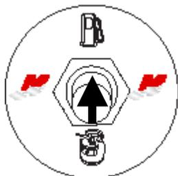
2. Mettre la commande en position supérieure (il est recommandé de faire tourner le moteur à 1 500 tr/mn pour cette opération).
