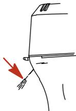
Si de l'eau ne s'écoule pas de la pompe à eau ou si le jet est intermittent, arrêter le moteur et vérifier que les orifices d'admission d'eau de refroidissement ne sont pas bouchés. En cas d'absence d'obstruction, un blocage dans le circuit de refroidissement ou un problème avec la pompe à eau est probable. Faire vérifier le hors-bord par le revendeur. Le moteur sera endommagé s'il surchauffe.
