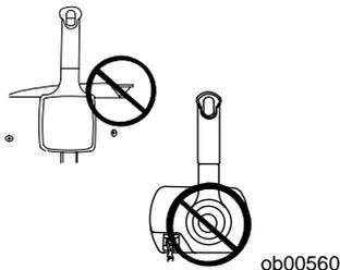
**REMARQUE :** Démarrage des moteurs noyés – Ramener le levier de ralenti accéléré au point mort en position haute maximale et continuer à lancer le moteur pour le démarrage.
