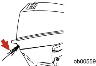
**IMPORTANT :** Si aucune eau ne s'écoule de l'orifice de la pompe, arrêter le moteur et vérifier que la prise d'eau de refroidissement n'est pas bouchée. S'il n'y a aucune obstruction, la pompe à eau peut être défectueuse ou le circuit de refroidissement peut être bouché. Dans ces cas, le moteur va surchauffer. Faire vérifier le moteur par le revendeur. Le moteur sera endommagé s'il surchauffe.
