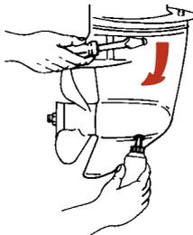
6. Retirer le tube de lubrifiant et remettre le bouchon de remplissage/vidange et la rondelle d'étanchéité en place après les avoir nettoyés.
