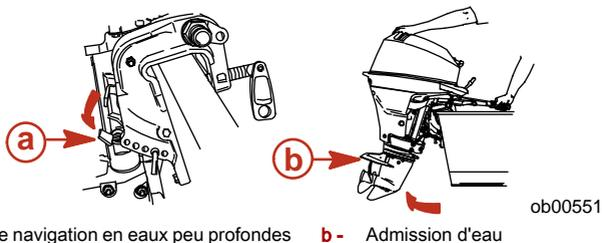
**IMPORTANT :** Lorsque ce mécanisme est actionné, ne pas engager la marche arrière. Maintenir le moteur à vitesse réduite et veiller à ce que la prise d'eau de refroidissement soit immergée.
