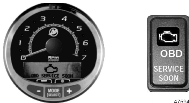
Instrument SC 1000 et voyant d'anomalie du moteur
