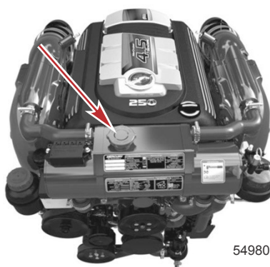
Bouchon de l'échangeur de chaleur
