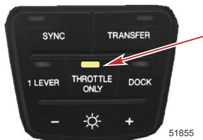
Bouton « THROTTLE ONLY » (Mode spécial d'accélération)
