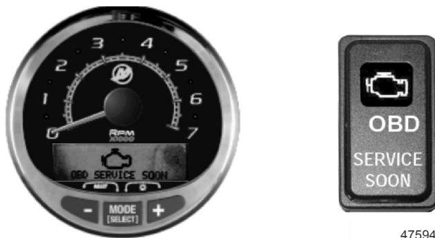
Instrument SC 1000 et voyant d'anomalie du moteur
