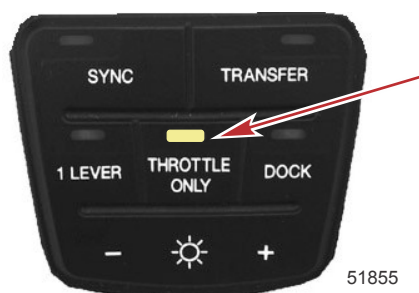
Bouton « THROTTLE ONLY » (Mode spécial d'accélération)
