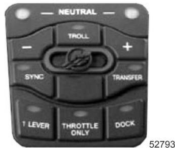
Pavé tactile du DTS monté sur le tableau de bord
