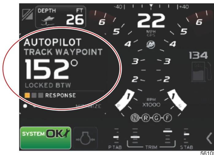
**REMARQUE :** Les boutons Turn (Tourner) du pavé du pilote automatique ne déclenchent pas de virage lorsque le mode Track waypoint (Suivi de point de cheminement) est activé. La fonction de virage n'est disponible qu'en mode Auto Heading (Cap automatique).
