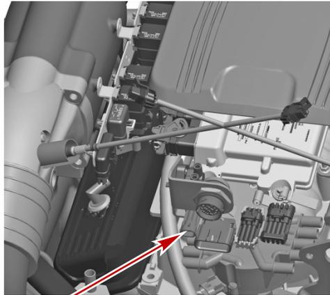
Connexion du faisceau d'alimentation – 5.0 MPI ECT
