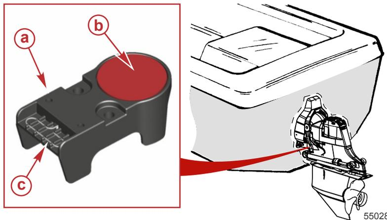
Le dispositif MerCathode est monté sous le carter de cloche, selon modèle.
