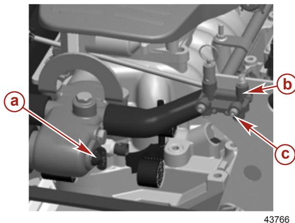
7. Vérifier que l'eau s'écoule par chaque ouverture. Si tel n'est pas le cas, suivre les instructions de la rubrique **Système de vidange manuel à 3 points manuel**.
