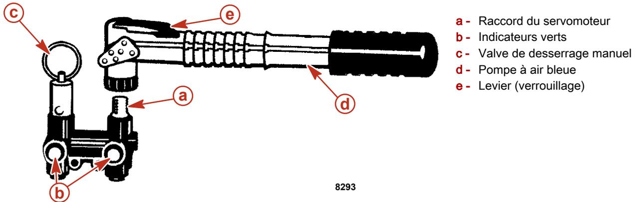
6. Pomper de l'air dans le système jusqu'à ce que les deux indicateurs verts ressortent et que de l'eau s'écoule des deux côtés du moteur. Le côté bâbord commence à se vidanger avant le côté tribord.
