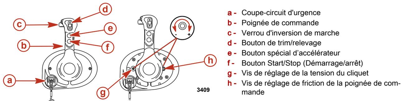
**Coupe-circuit d'urgence** – Désactive l'allumage chaque fois que le pilote (lorsqu'il est attaché au coupe-circuit d'urgence) s'éloigne suffisamment du poste de pilotage pour activer le contacteur. Voir **Coupe-circuit d'urgence** pour plus de détails sur l'utilisation de ce contacteur.
