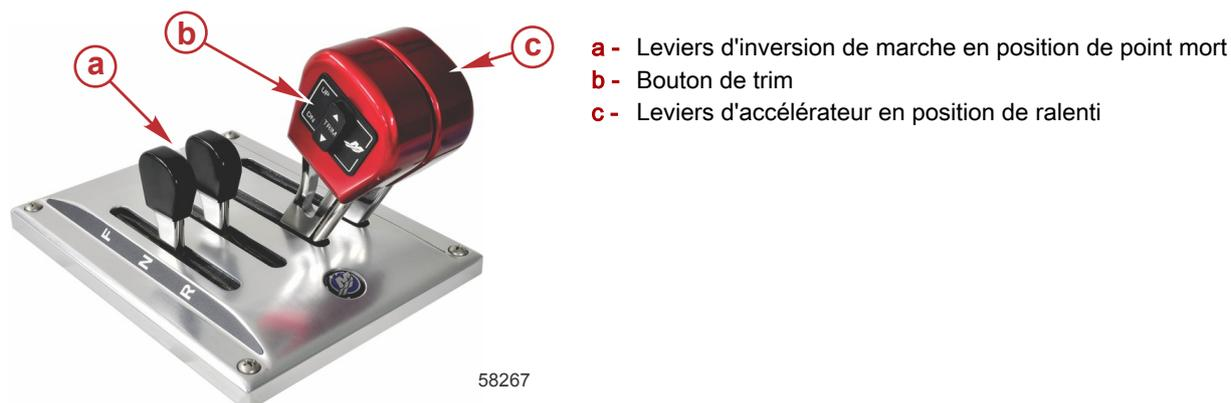
**Levier d'inversion de marche** – Les fonctions d'inversion de marche sont contrôlées par le déplacement du levier d'inversion de marche. Passer en marche arrière en déplaçant le levier d'inversion de marche en position arrière. Passer au point mort en déplaçant le levier d'inversion de marche vers sa position centrale. Passer en marche avant en déplaçant le levier d'inversion de marche vers sa position avant.
