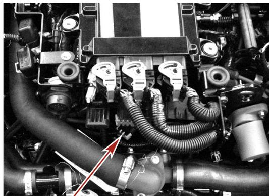
Connexion du faisceau d'alimentation – 4.3 MPI ECT, couvercle retiré pour la clarté de l'image
