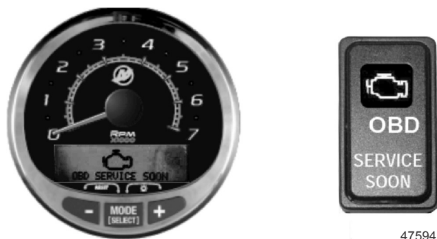
Instrument SC 1000 et voyant d'anomalie du moteur
