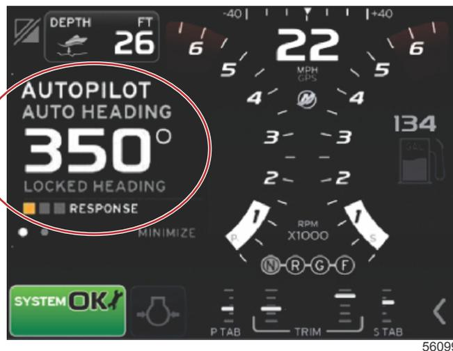
5. Pour régler la course lorsque le mode Auto heading (Cap automatique) est activé, voir **Réglage de la course en utilisant les boutons « Turn » (Tourner) ou la manette**.
