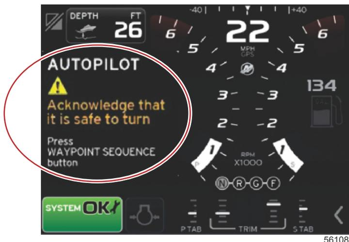
2. Si le point de cheminement suivant peut être sélectionné en toute sécurité, le pilote doit appuyer sur **WAYPOINT SEQUENCE (Séquence de points de cheminement)** pour confirmer le point de cheminement. Le pilote automatique fait automatiquement virer le bateau et le manœuvre vers sa nouvelle route.
