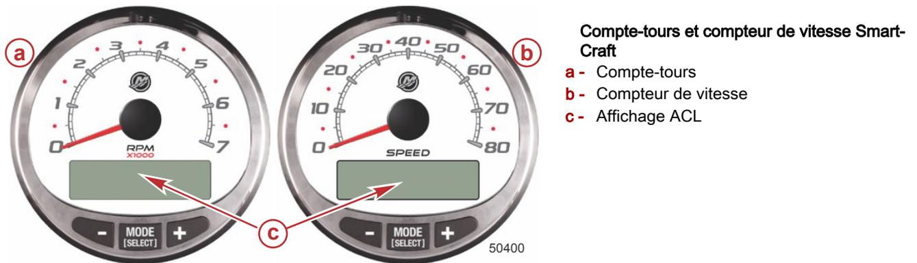
Le jeu d'instruments SmartCraft facilite aussi l'identification des codes de panne associés au système d'alarme sonore du moteur. Le jeu d'instruments SmartCraft affiche les données d'alarme critique et d'autres problèmes potentiels sur son écran ACL.
