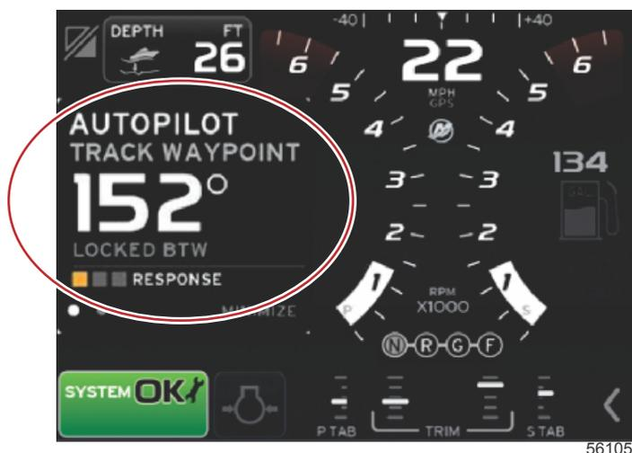
**REMARQUE :** Les boutons Turn (Tourner) du pavé du pilote automatique ne déclenchent pas de virage lorsque le mode Track waypoint (Suivi de point de cheminement) est activé. La fonction de virage n'est disponible qu'en mode Auto Heading (Cap automatique).
