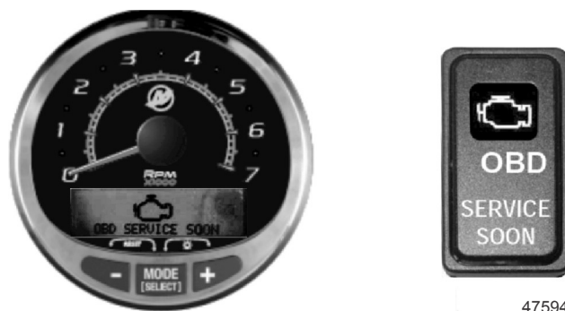
Instrument SC 1000 et voyant d'anomalie du moteur
