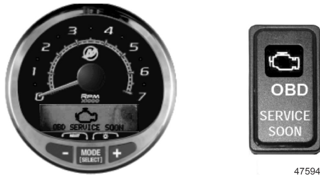
Instrument SC 1000 et voyant d'anomalie du moteur
