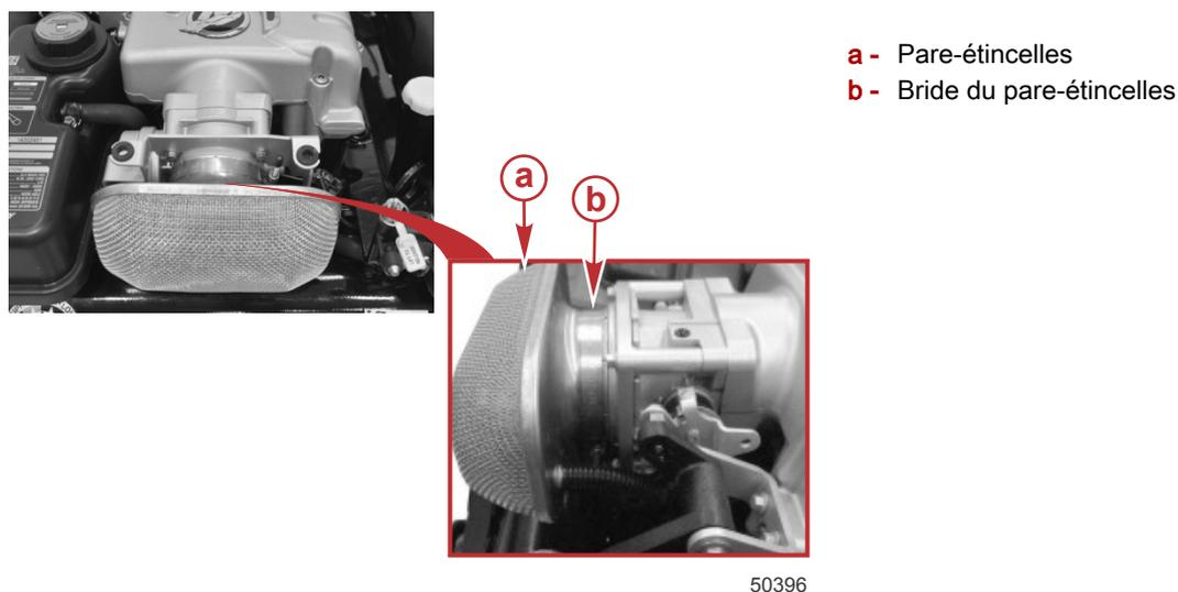
3. Nettoyer le pare-étincelles avec un solvant et le sécher à l'air comprimé ou le mettre de côté et le laisser complètement sécher à l'air.
