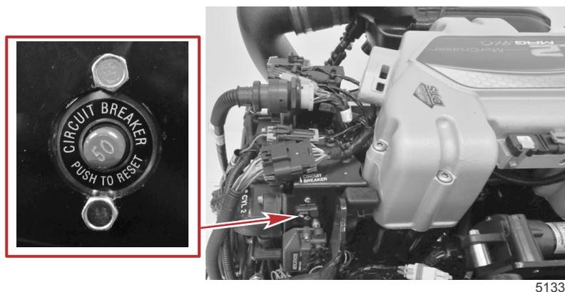
Un fusible de 90 A, situé sur la grosse borne du solénoïde du démarreur, protège le faisceau de fils du moteur contre les surcharges électriques.
