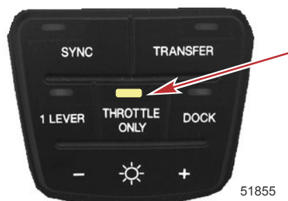
Bouton « THROTTLE ONLY » (Mode spécial d'accélération)
