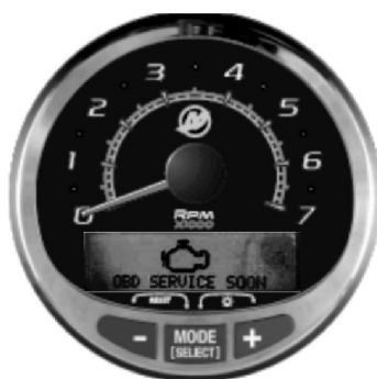
Instrument SC 1000 et voyant d'anomalie du moteur
