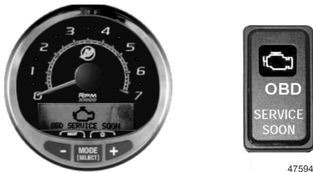
Instrument SC 1000 et voyant d'anomalie du moteur
