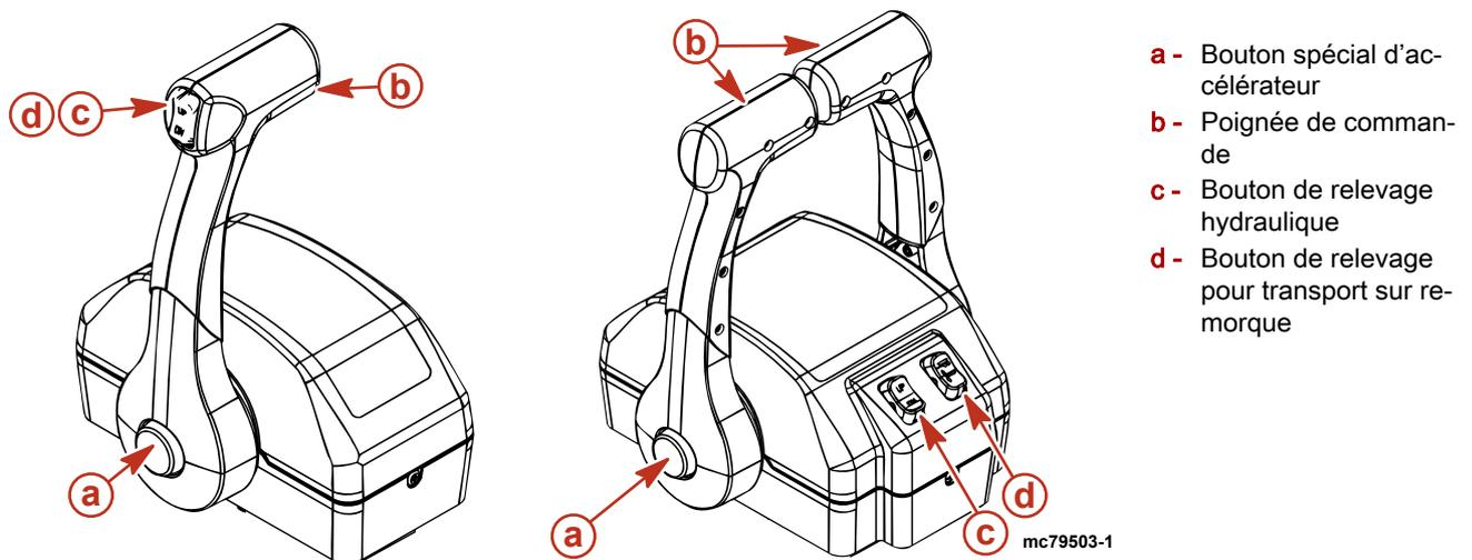
**Bouton spécial d'accélération** – Permet d'augmenter le régime moteur sans mettre le moteur en prise. Le mécanisme de l'inversion de marche est alors désolidarisé de la poignée de commande. Le bouton spécial d'accélération ne peut être enfoncé que lorsque la poignée de commande est au point mort.
