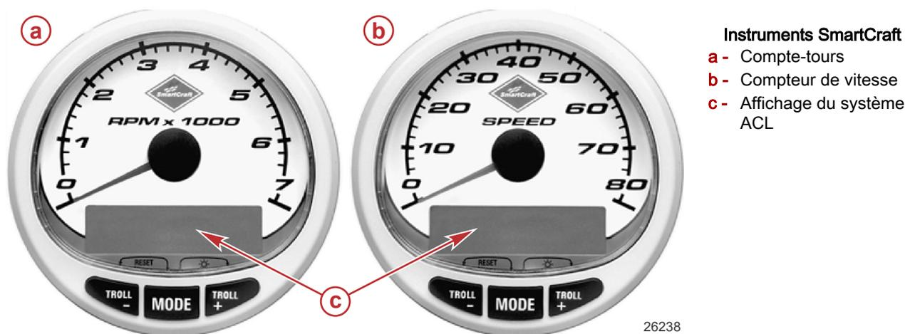
L'ensemble d'instruments SmartCraft facilite également les diagnostics du système Engine Guardian. L'ensemble d'instruments SmartCraft affiche des données d'alarmes graves relatives au moteur, ainsi que les problèmes potentiels. Se reporter au manuel fourni avec l'ensemble d'instruments pour connaître les fonctions d'alerte surveillées et le fonctionnement de base de l'ensemble d'instruments SmartCraft.
