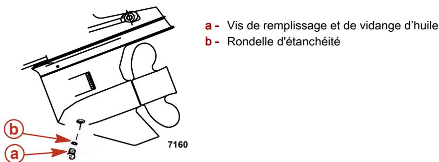
5. Retirer la vis de purge d'huile ainsi que la rondelle d'étanchéité. Laisser l'huile s'écouler complètement.
