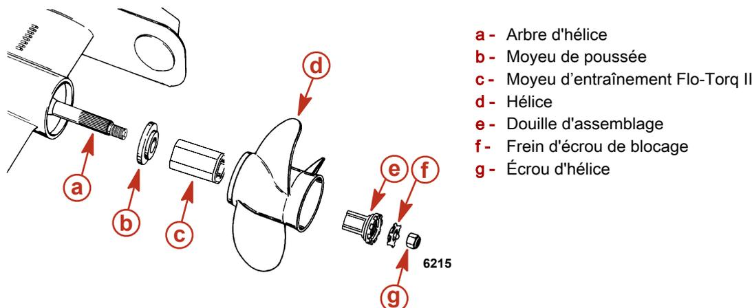
1. Enfiler le moyeu de poussée sur l'arbre d'hélice en plaçant le côté cranté vers le moyeu d'hélice.
