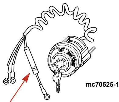
5. Le système de relevage hydraulique est protégé contre les surcharges par un fusible de 110 A et un fusible à lamelle de 20 A situés sur la pompe de relevage hydraulique. La pompe de trim peut aussi être dotée d'un dispositif de protection du circuit en ligne dans le fil positif de relevage hydraulique, près de l'interrupteur de batterie ou de la connexion de la batterie.
