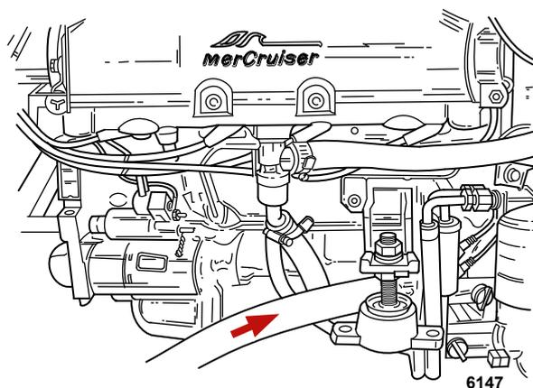
6. À l'aide d'un adaptateur approprié, brancher le tuyau de nettoyage, provenant de l'alimentation en eau, à l'arrivée d'eau de la pompe à eau de mer.
