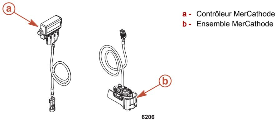
Kit d'anodes (selon modèle) - Monté sur le tableau arrière du bateau.
