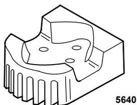
**Système MerCathode** - L'ensemble d'électrodes remplace le bloc anodique. Vérifier la sortie du système pour s'assurer qu'elle est correcte. Le test doit être effectué lorsque le bateau est amarré ; pour ce faire, utiliser l'électrode de référence et le contrôleur Quicksilver. Contacter un revendeur agréé Mercury MerCruiser.
