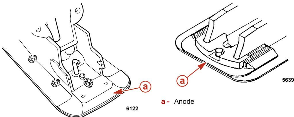
Bloc anodique monté sur l'embase (selon modèle) - Monté sous le carter de cloche
