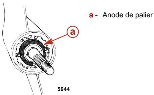
Anode d'arbre d'hélice (Bravo Three) - Située derrière l'hélice arrière.
