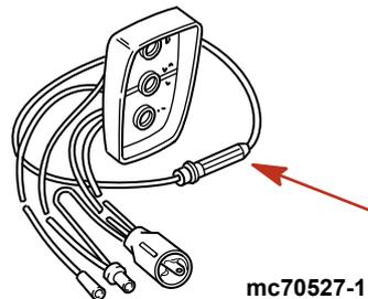
7. Le système MerCathode de Quicksilver est protégé par un fusible de 5 A qui se connecte à la borne positive (+) du contrôleur. Si ce fusible est grillé, le système n'assure pas sa fonction de protection anticorrosion.
