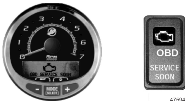
Instrument SC 1000 et voyant d'anomalie du moteur
