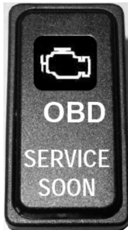
Témoin d'anomalie du moteur
