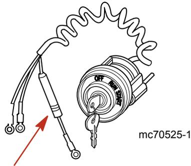
Le système de relevage hydraulique est protégé contre les surcharges par un fusible de 110 A et un fusible à lamelle de 20 A situés sur la pompe de relevage hydraulique. La pompe de trim peut aussi être dotée d'un dispositif de protection du circuit en ligne dans le fil positif de relevage hydraulique, près de l'interrupteur de batterie ou de la connexion de la batterie.
