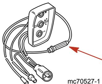
Le système MerCathode de Quicksilver est équipé d'un fusible en ligne de 20 A situé sur le fil qui relie la borne positive (+) du contrôleur. Si le fusible est grillé, le système ne fonctionne pas et ne protège pas le moteur contre la corrosion.
