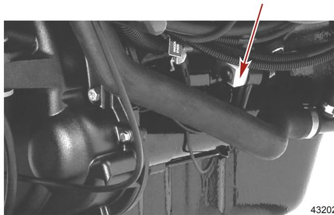
Quatre fusibles protègent les circuits d'alimentation principale, de pompe à carburant, d'allumage et des accessoires. Ils sont situés au dessus du moteur, près du PCM. Quatre fusibles de 10 A protègent les capteurs d'O<sub>2</sub>. Ils sont situés près du connecteur du faisceau à 14 broches.
