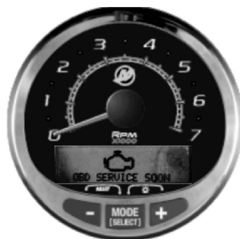
Instrument SC 1000 et voyant d'anomalie du moteur
