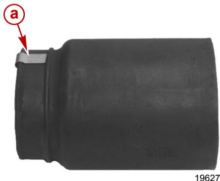
Attache de mise à la terre du tube d'échappement illustrée, attaches de masse des soufflets de joint de cardan similaires
