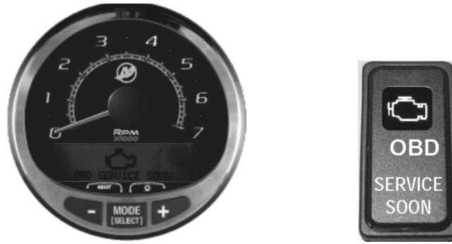
Instrument SC 1000 et voyant d'anomalie du moteur
