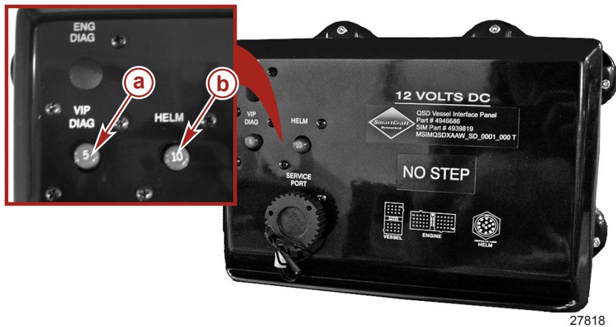
Coupe-circuits du panneau d'intégration du bateau (VIP)
