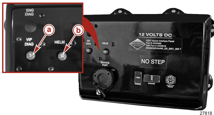
Coupe-circuits du panneau d'intégration du bateau (VIP)
